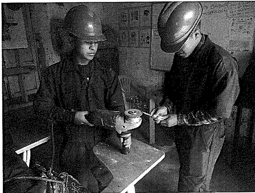
Participantes del taller de construcción manipulando pulidora con disco para pulir metal realizando afilado de espátulas para continuar con el raspado de pintura en el museo casa de la cultura.
