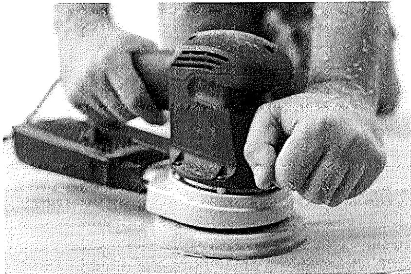
Lijadora orbital para el abrillantado de muebles.
